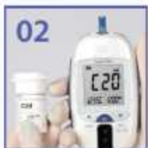
۲- سپس کد نمایش داده شده توسط دستگاه را با کد روی حصه نواری تست قند تطبیق دهید
