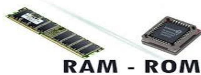
**RAM**: حافظه ناپایدار و متغیر است. قابل تغییر است و هرچه در RAM ذخیره شده باشد با خاموش شدن دستگاه، از بین خواهد رفت.
