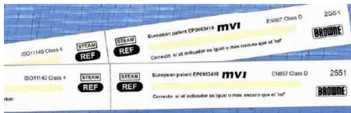
شکل ۷. شمایی از نشان‌گرهای چند پارامتری استریلیزاسیون
